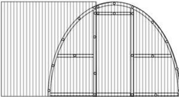
Mit dem dritten und restlichen Teil des Polycarbonates bedecken Sie die noch offenen Stellen der Frontseiten und schrauben diese ebenfalls fest. Schneiden Sie die hinausragenden Kanten entlang des Rahmens mit einem Cuttermesser ab.
