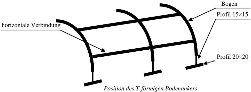
Installieren Sie auf diese Weise die verbleibenden Bodenanker. Graben Sie passende Löcher im Boden in der Nähe der Bögen aus, auf denen die Bodenanker montiert sind. Stellen Sie das zusammengebaute Gewächshaus so auf, dass der untere Rahmen bodenbündig ist und die Beine in den Boden hineinragen. Verschütten Sie die ausgegrabenen Löcher mit Erde und stampfen Sie sie. Für die Installation des Gewächshauses können Sie auch einen Holzrahmen oder ein Betonfundament verwenden
