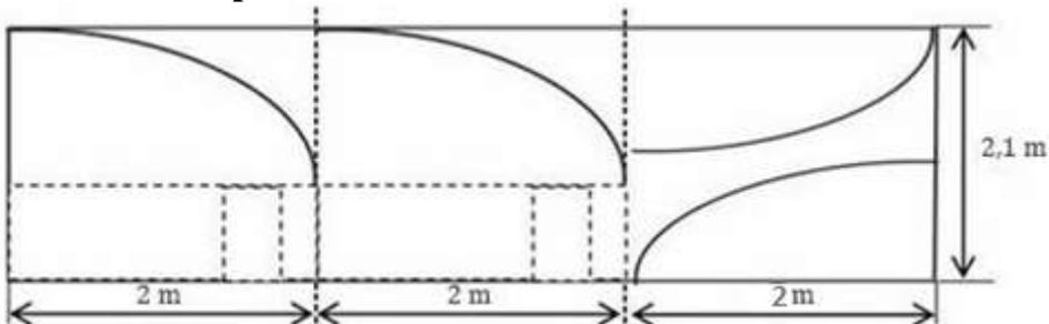
*Schnittmuster für Polycarbonat-Hohlkammerplatten (6,0x2,1 m) zum Verkleiden der Frontseiten des Gewächshauses*
