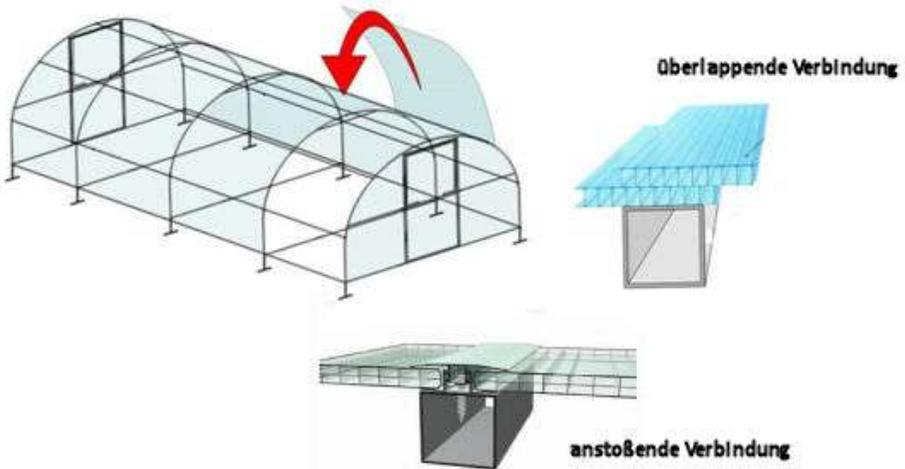
**WICHTIG! AUFGRUND MÖGLICHER RADIUSUNTERSCHIEDE EINZELNER FRONTSEITEN Z.B. DURCH LAGERUNG ODER TRANSPORT MUSS DIE POLYCARBONATPLATTE ZU JEDEM FRONTSEITENRAHMEN FÜR SICH GESCHNITTEN WERDEN, UM DIE PASSEIT DER PLATTE ZUM RAHMEN ZU GARANTIEREN!**
