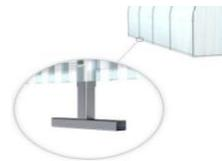
Abb. 13 Zusammenbau des Bodenankers (T-Fuß)
