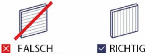
Abb.4 Die Richtung der Position der Platte aus Hohlkammer-Polycarbonat an den Frontseiten des Gewächshauses
